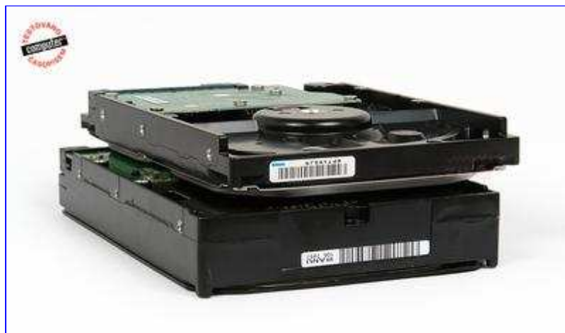
Větší hustota zápisu dat na jednu plotnu umožnila výrobu disků s nižším profilem
