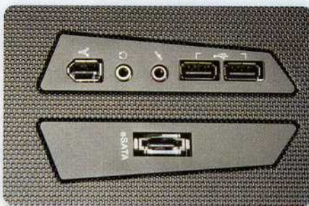
Externé porty umiestnené zvonka počítačovej zostavy pomáhajú pri pohodlnejšej manipulácii; v tomto prípade je tu aj špecialita – externý port SATA na pripojenie vonkajšieho pevného disku
