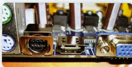
Moderné prepojenie počítača s LCD televízormi sa volá HDMI, prenáša sa ním zvuk aj obraz v HD kvalite; čoraz častejšie sa objavuje aj na základných doskách
