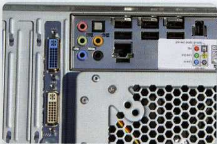
Typické usporiadanie portov v počítačovej zostave – dnes je požiadavka na veľa portov USB, pripojenie do počítačovej siete, analógový a optický prenos zvuku; na pripojenie k monitoru sa používa port DVI
