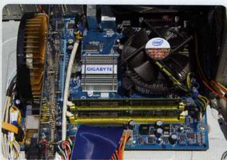
Za minimum pamäte RAM považujeme dnes 2 GB, najlepšie v dvoch moduloch
